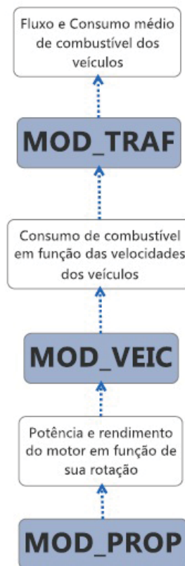
Figura 4.1: Esquema do relacionamento entre os modelos que integram motor, veículo e tráfego.
